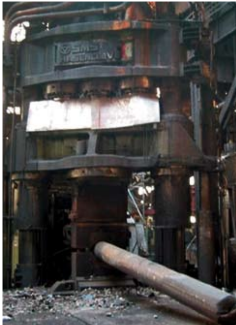
Zustand der Freiformschmiede nach dem Brand
